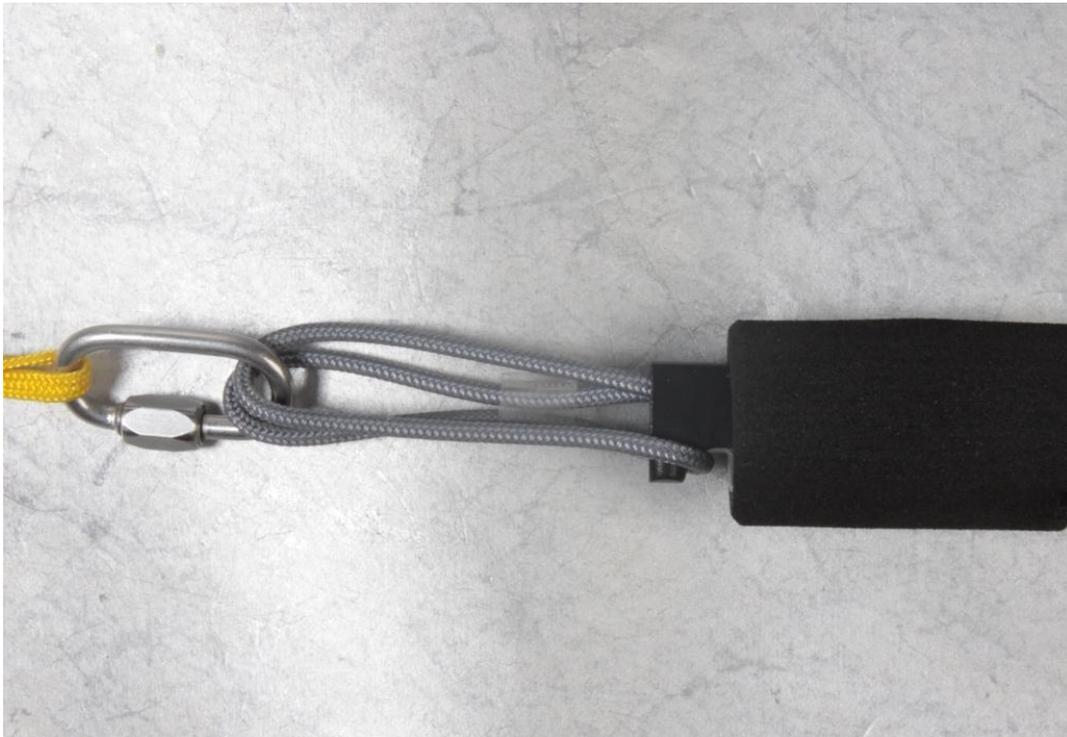
Abbildung 5.2: Einhängen des Befestigungsseils
