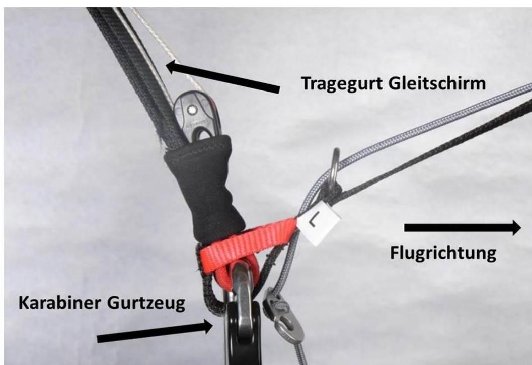
Abbildung 4.1: Detailsicht der Einhängung am linken Karabiner des Gurtzeuges
