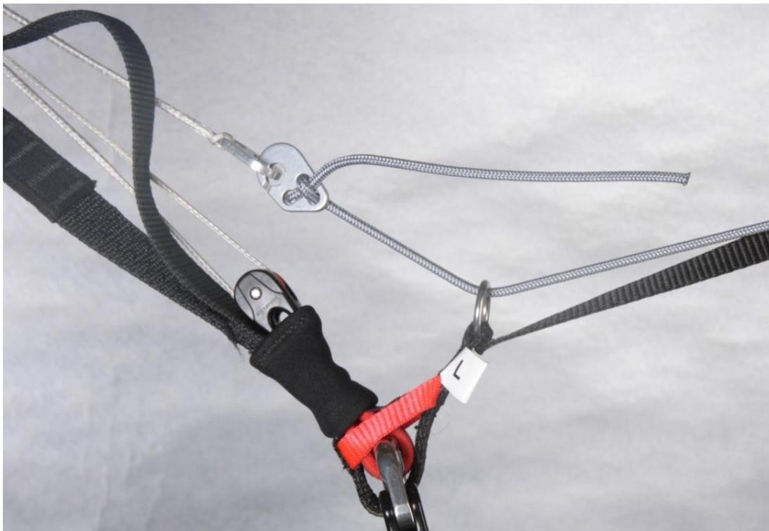
Abbildung 4.3: Einhängen des Vorbeschleunigers
