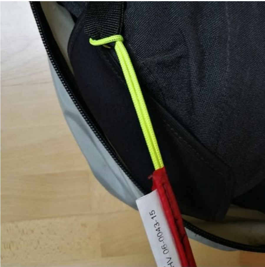
Abb. 5.1 Klinkenseil in Gurtschlaufe einschlaufen
