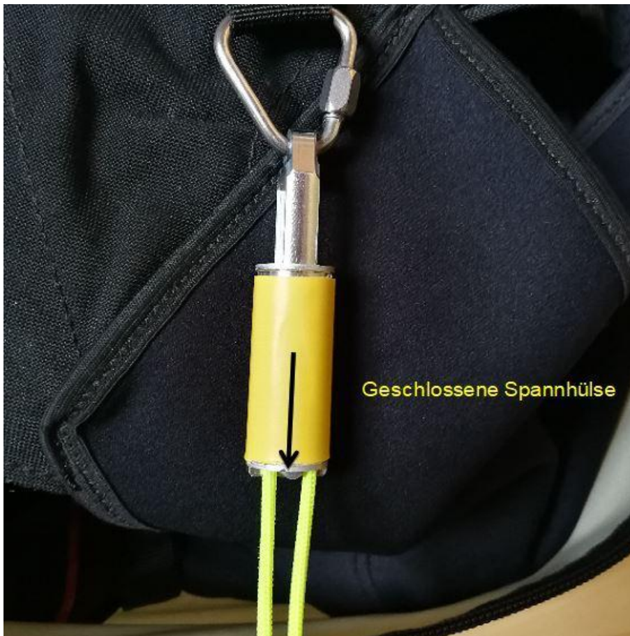
Abb. 5.4: Schließen der Klinke durch Vorschieben der Hülse
