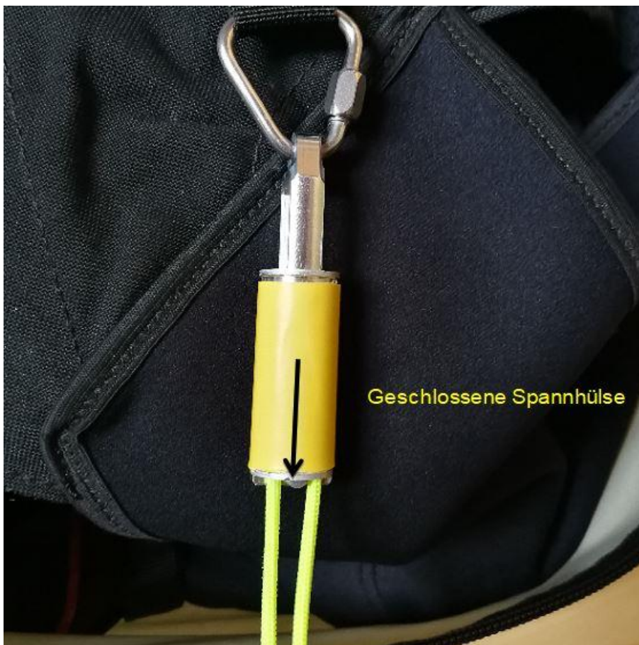
Abb. 5.4: Schließen der Klinke durch Vorschieben der Hülse
