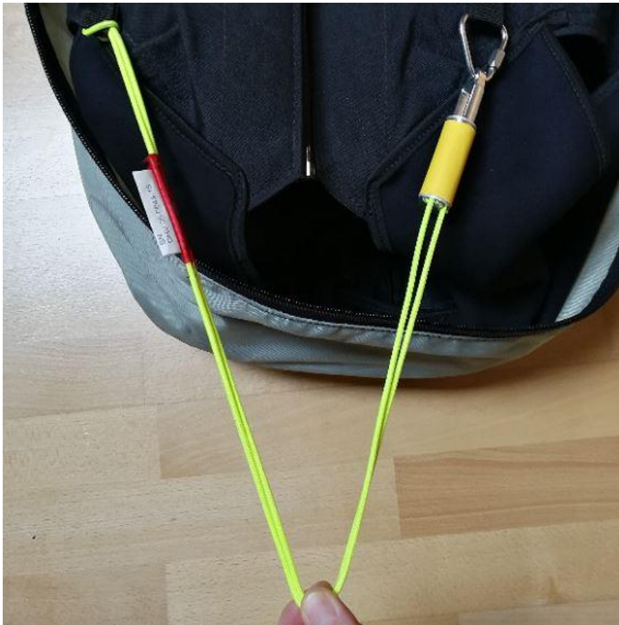
Abb. 5.5: Schleppklinke im startbereiten Zustand
