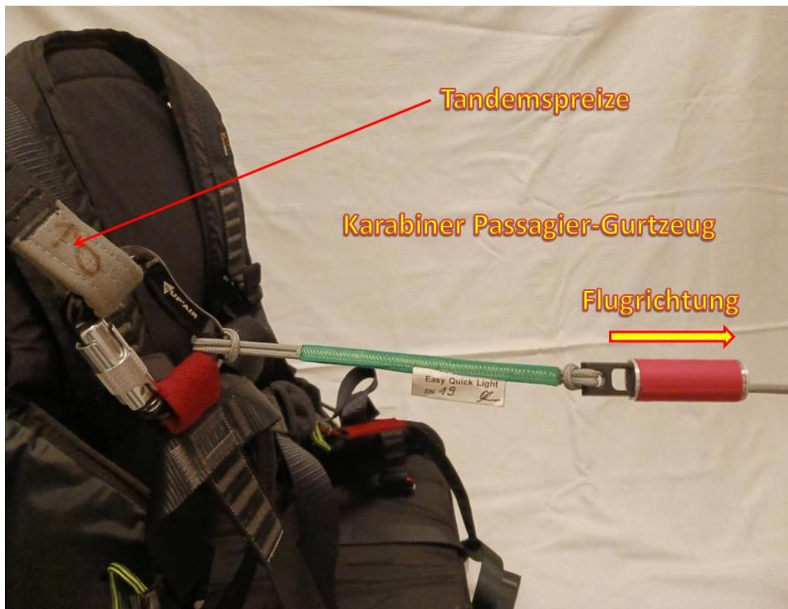
Abbildung 4.1b: Detailansicht der Einhängung am rechten Karabiner des Passagier-Gurtzeuges
