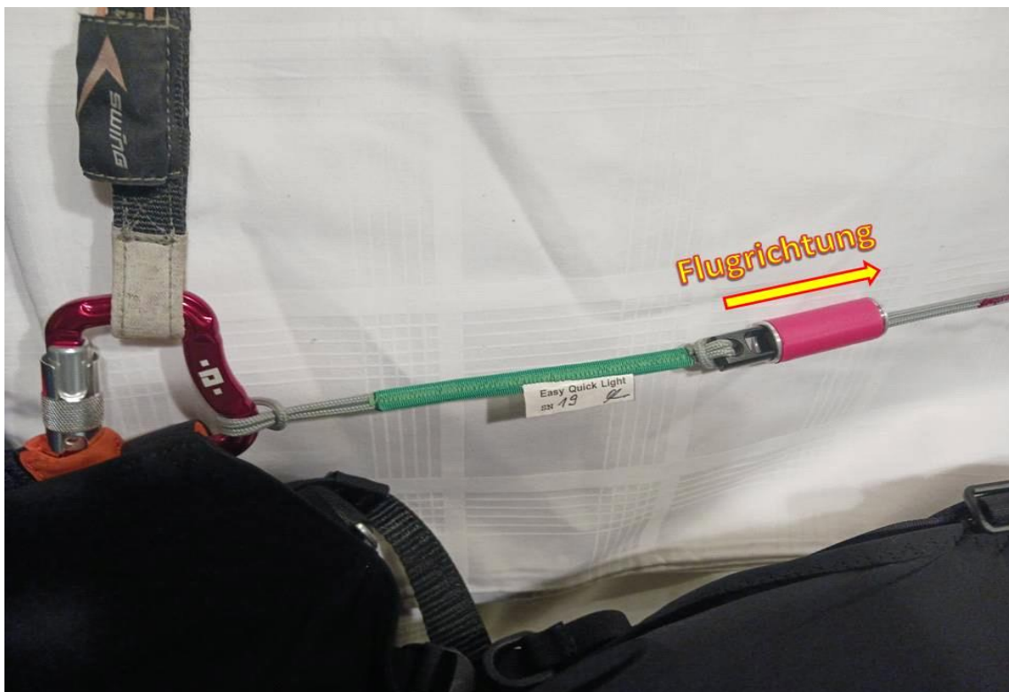
Abbildung 4.1a: Detailansicht der Einhängung am rechten Karabiner bei Solo Schlepp
