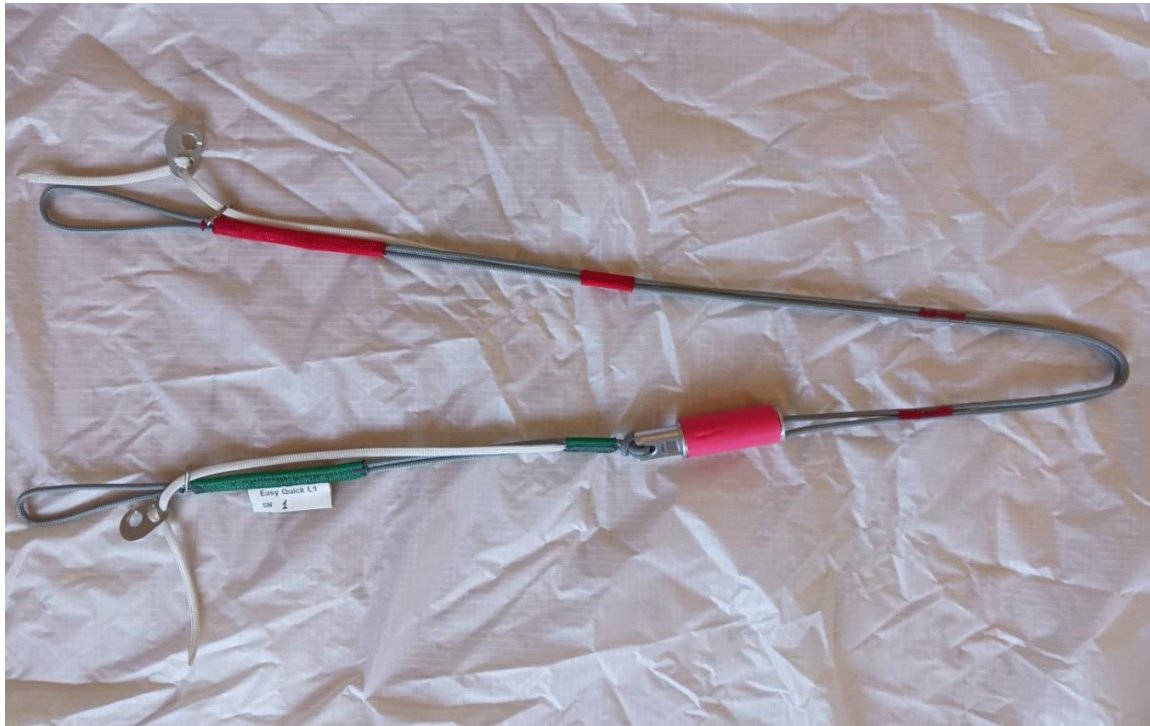
Abbildung 4.2: Farbliche Markierung der Schleppklinke (Draufsicht)
