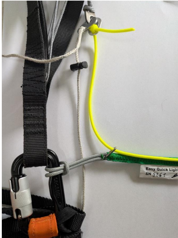
Abbildung 4.3: Einhängen des Vorbeschleunigers
