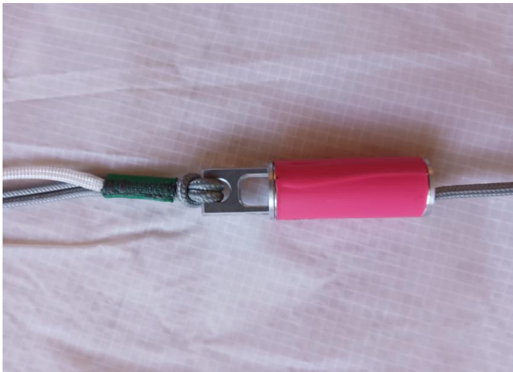
Abbildung 5.3: Schleppklinke im startbereiten Zustand
