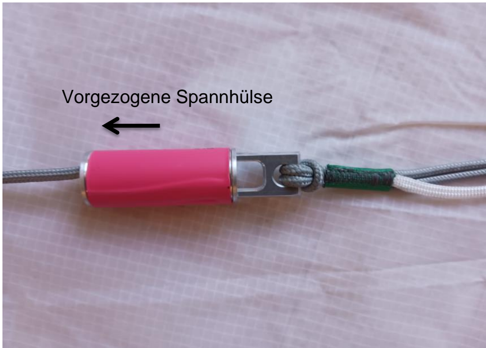
Abbildung 5.3: Schleppklinke im startbereiten Zustand
