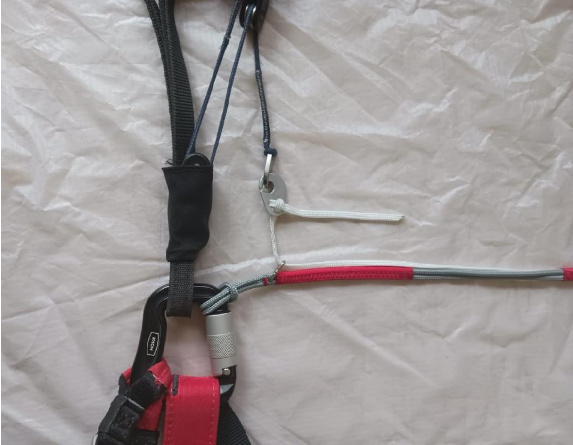
Abbildung 4.3: Einhängen des Vorbeschleunigers
