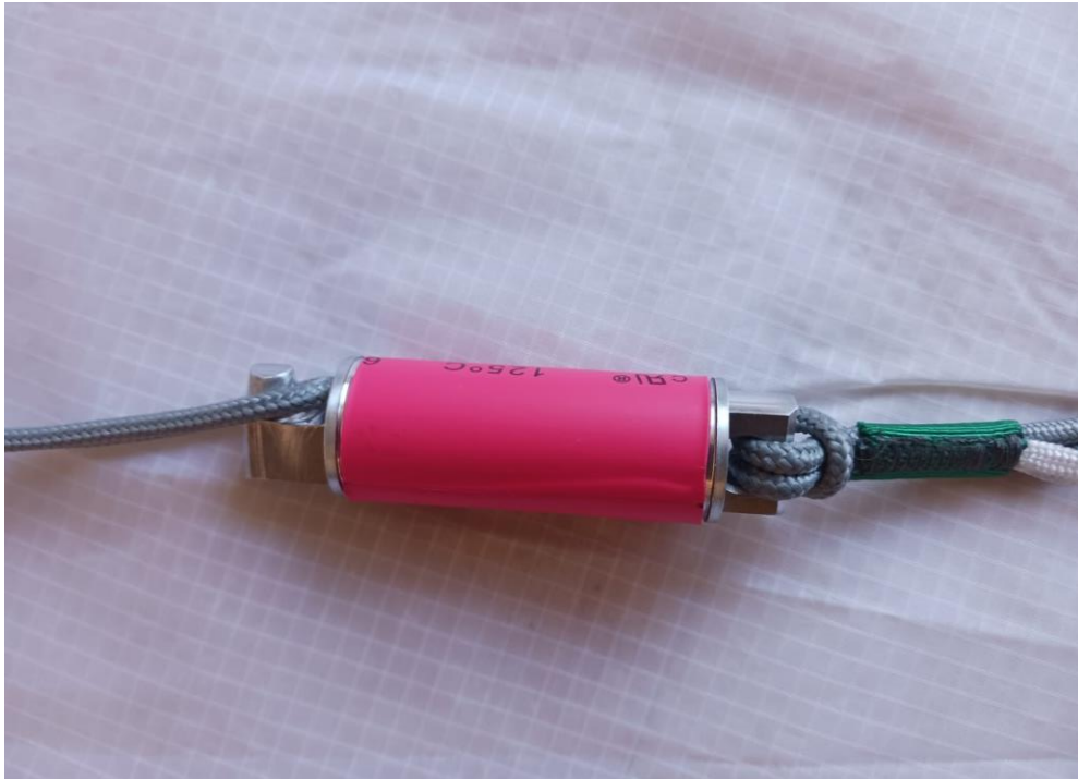
Abbildung 5.2: Einhängen des Befestigungsseils
