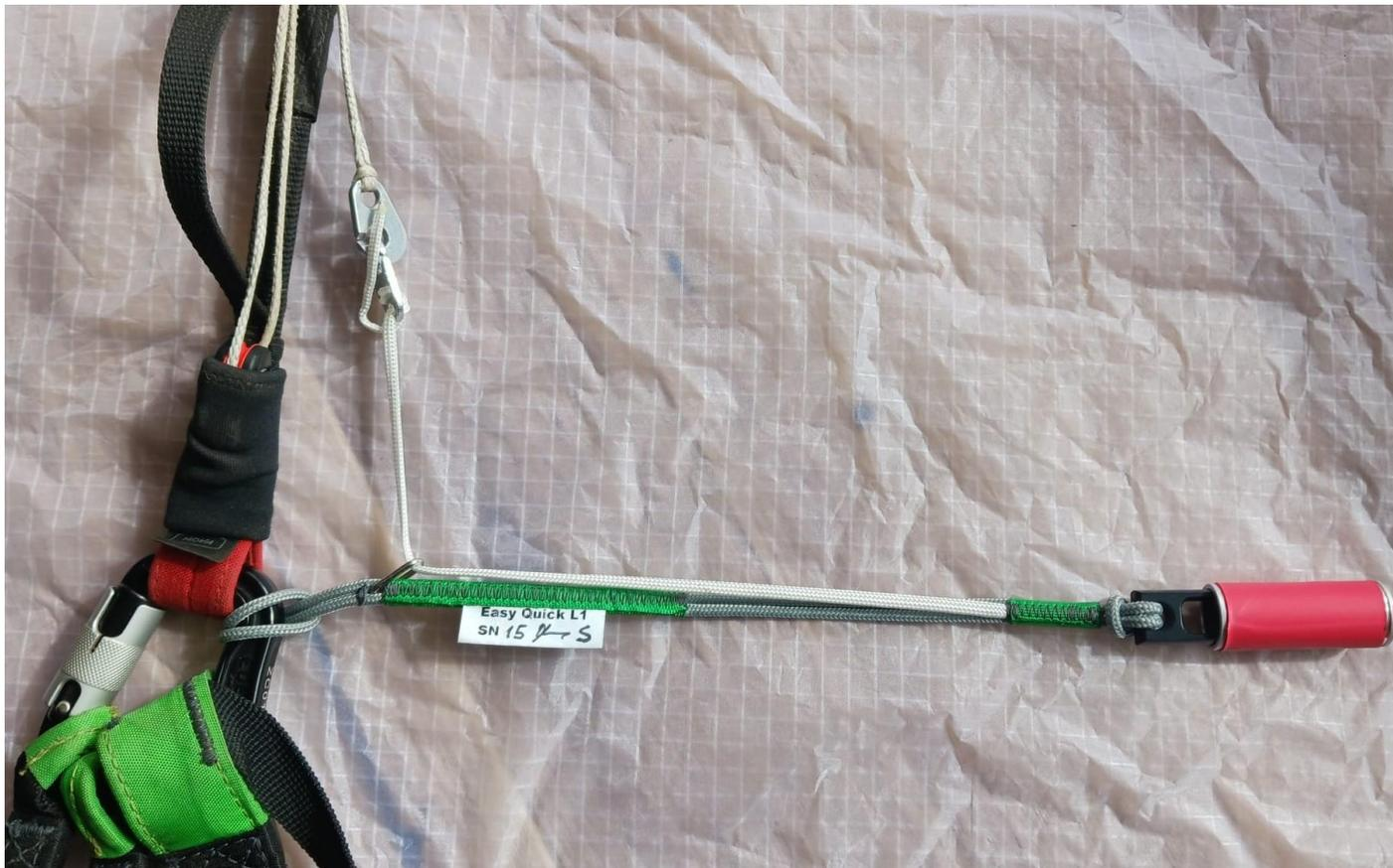
Abbildung 4.3: Einhängen des Vorbeschleunigers
