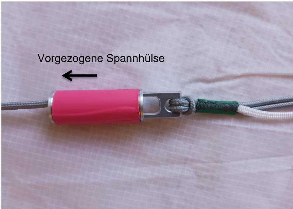
Abbildung 5.3: Schleppklinke im startbereiten Zustand
