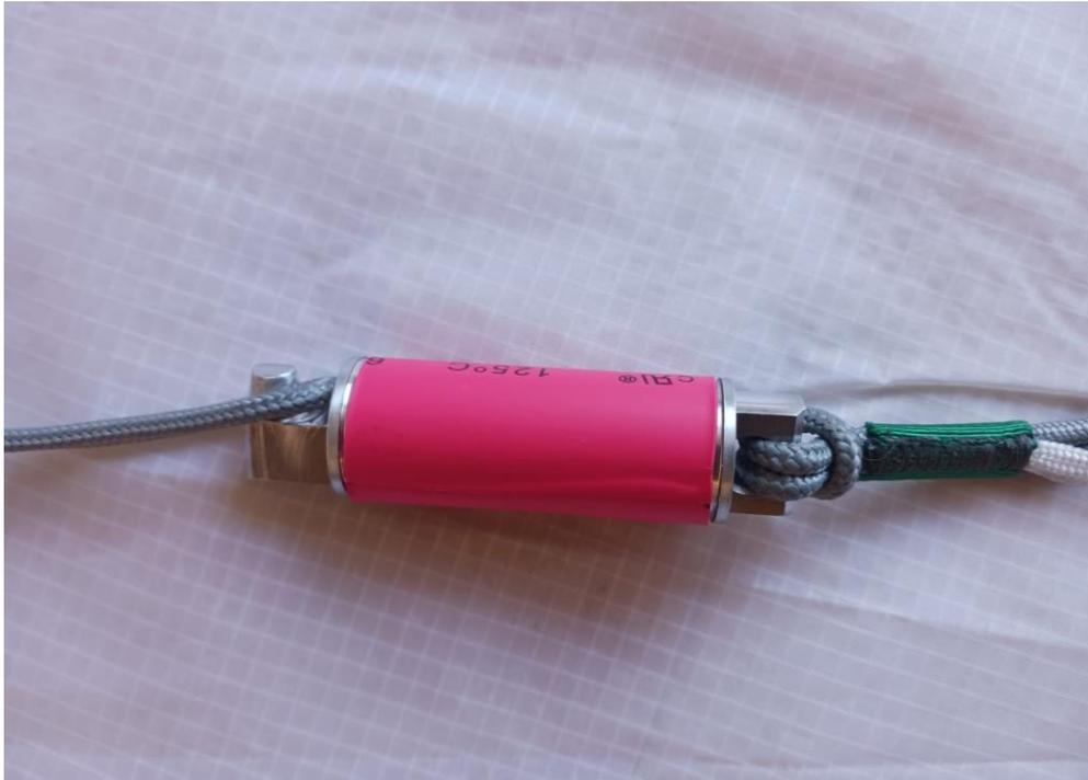
Abbildung 5.2: Einhängen des Befestigungsseils
